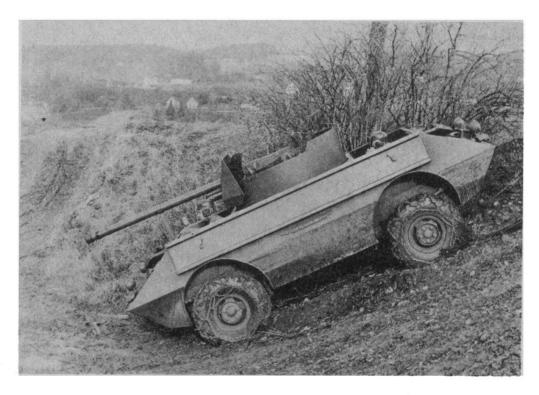
Fig. 2. — Véhicule antichars à double conduite. Direction des quatre roues. Canon 9 cm.
