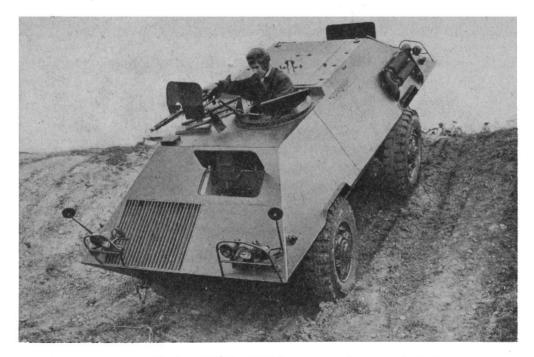
Fig. 1. — MOWAG « SPW ». Véhicule pour transport de troupes
