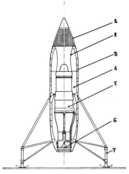
Fig. 1. — Coupe du C-400 P.1: 1) Entrée d'air grillagée ; 2) Conduit d'air du réacteur ; 3) Carénage ; 4) Réservoirs de carburant ; 5) Réacteur S.N.E.C.M.A. « Atar 100 D 3 » ; 6) Tuyère directionnelle ; 7) Train d'atterrissage.
