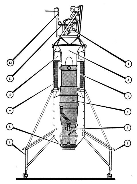
Fig. 2. — Voici le croquis de l'« Atar Volant » C-400 P.2 vu en coupe. 1) Siège éjectable ; 2) Entrée d'air protégée par une grille ; 3) Réservoirs de carburant ; 4) Réacteur E.3.V ; 5) Electrovannes contrôlant le débit de la tuyère directionnelle et des buses de roulis ; 6) Buses de roulis ; 7) Atterrisseur oléo-pneumatique ; 8) Tuyère directionnelle ; 9) Carénage du réacteur ; 10) Système de stabilisation ; 11) Manette des gaz et manche à balai ; 12) Tableau de bord.
