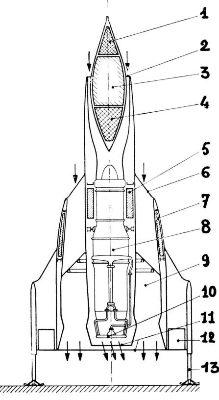
Fig. 3. — Comment se présentera le « Coléoptère ». Vue en coupe : 1) Radar ; 2) Entrée d'air du turboréacteur ; 3) Cabine de pilotage ; 4) Accessoires ; 5) Nourrice ; 6) Entrée d'air du stato ; 7) Carburant ; 8) Turboréacteur ; 9) Chambre du stato ; 10) Tuyère ; 11) Sorties des turbo et statoréacteurs ; 12) Gouvernes ; 13) Atterrisseurs.
