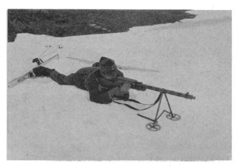
Fig. 5. — Le Fm. prise de position dans la neige avec appui antérieur retourné et fixé devant l'anneau de bretelles.
