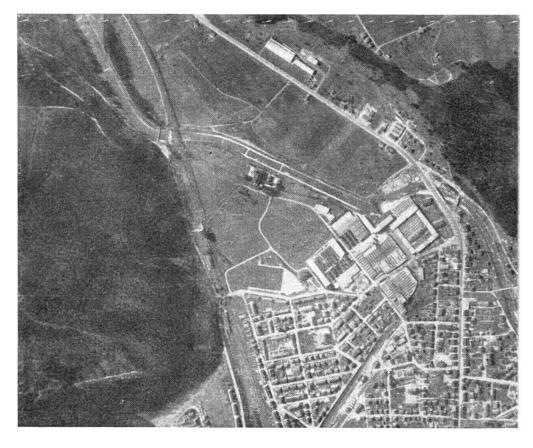
Prise de vue verticale à haute altitude avec caméra à grande distance focale. Hauteur sur l'objet  $9500~\mathrm{m}$ .
