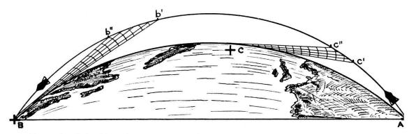
Du point B la détection ne sera possible, en b' - b'', que sur la dernière partie du trajet de l'engin ; au point C, elle le sera déjà en c' - c'', soit peu après le lancement de l'engin en A.
