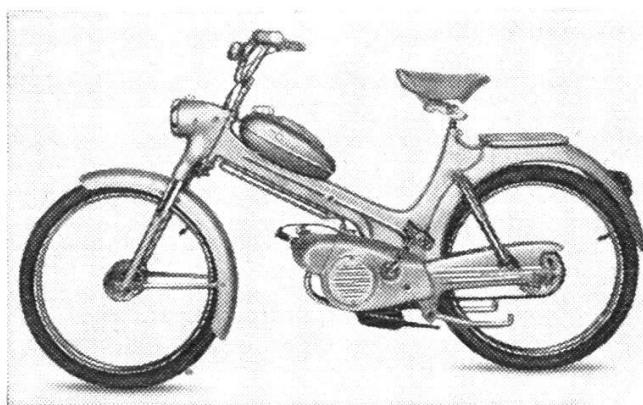
moteur refroidi par turbo-ventilateur puissance en côte = 19 %.
