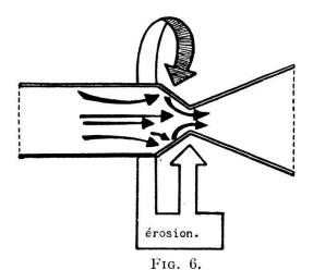
L'usure provient de la violence avec laquelle les gaz se précipitent et s'engousfrent dans l'étranglement arrière du tube du canon sans recul.
