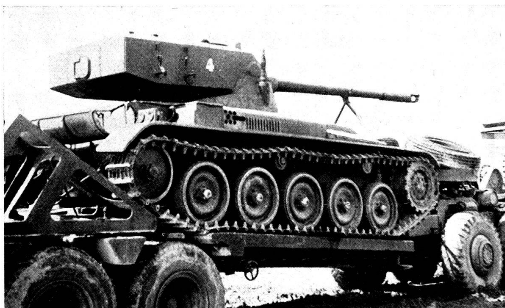
FIG. 1. — Char léger AMX sur son porte-char « Titan »-Berliet. Le dispositif triangulaire à gauche sert à caler l'engin pendant le transport ; entièrement renversé par pivotage, il forme rampe.
