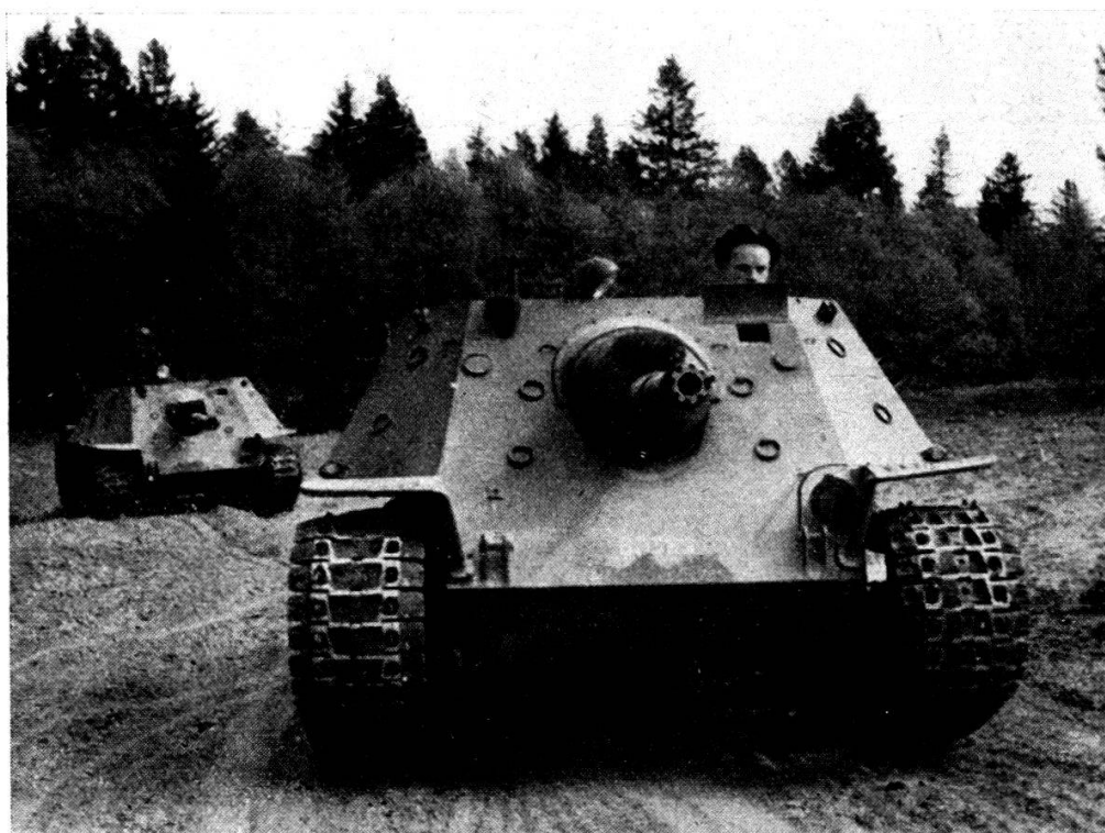
FIG. 5 et 6. — Canon d'assaut auto-porté Bofors-Landsverk de 105 mm M/53. Portée max. 7 km. Nombre d'obus de 12 kg. transportés : 20. Vitesse initiale : 475 m/s. Peut être pourvu d'un toit (blind. 5 mm). Autonomie : sur route 250-300 km., tous terrains 130-150 km. Angle de pente : 30 %. Largeur de franchissement : 1,50 m. Profondeur de passage de gué : 90 cm. Silhouette remarquablement basse (1,625 m.).
