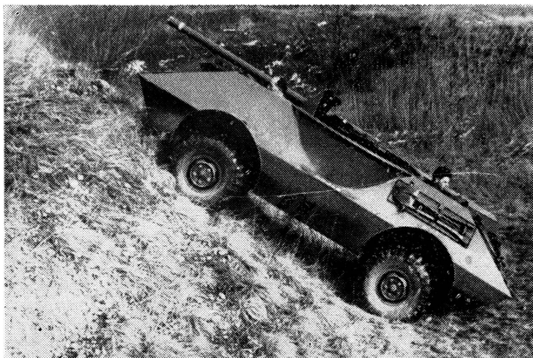
FIG. 3. — Chasseur de chars de 9 cm Mowag 1955. — La pièce abaissée en marche. Chaînes spéciales pour la boue.
