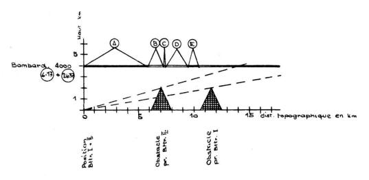
LÉGENDE: A. Tracé d'efficacité (dist. max. 7 km). — B. Prévision pour la durée par temp. max. pr S ¹. — C. Retard de charge. — D. Tracé pour saisir le but. — E. Temps pour décamoufler.
