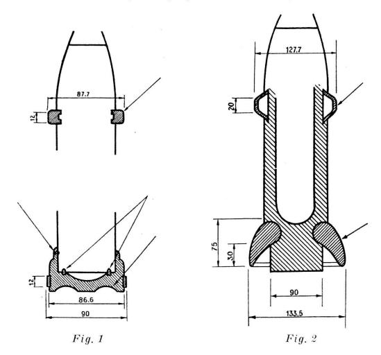
conique accouplé à la bouche de la pièce, à obtenir sa déformation, jusqu'à ce que les accessoires s'adaptent au calibre réel du projectile (les accessoires sont en fer doux).
