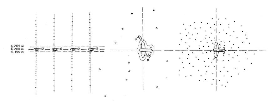
Fig. A. — Projection sur plan vertical de l'éclatement de 1000 coups.
