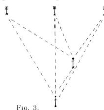
Voici un schéma d'un réseau radio à l'intérieur d'un bataillon d'infanterie avec appareils «SE 66».
