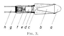
a= coiffe creuse ; b= cavité ; c= charge d'explosif ; d= relai ; e= détonateur ; f= amorce ; g= fusée ; h= tige de lancement.
