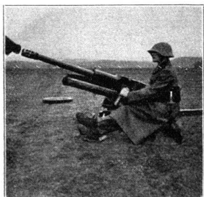
Le chef de pièce place son poing fermé exactement devant le tube. Puis il le meut dans différentes directions. Le pointeur le suit des yeux et dirige le tube dans la direction ainsi indiquée.
