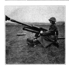
Le chef de pièce place son poing fermé exactement devant le tube. Puis il le meut dans différentes directions. Le pointeur le suit des yeux et dirige le tube dans la direction ainsi indiquée.
