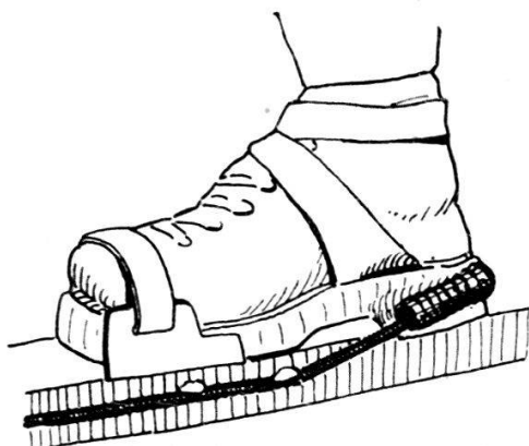
FIG. 3. — Traction diagonale, pied à plat.
