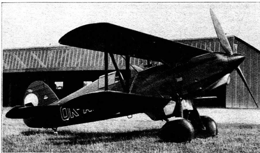
Monoplace de chasse tchécoslovaque « Avia », à moteur Hispano-Suiza de 750 C.V., construit sous licence en Tchécoslovaquie.
