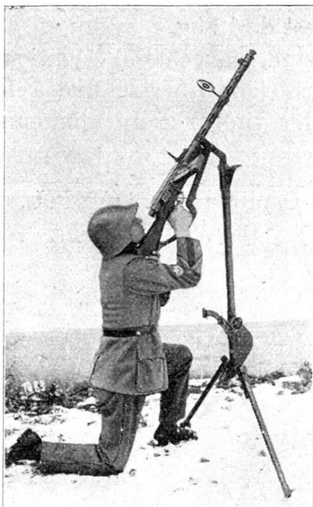
Fig. 4. L'affût dans la position de tir contre avions. L'articulation spéciale est sortie de la bêche et on a fixé le F.M. dessus.
