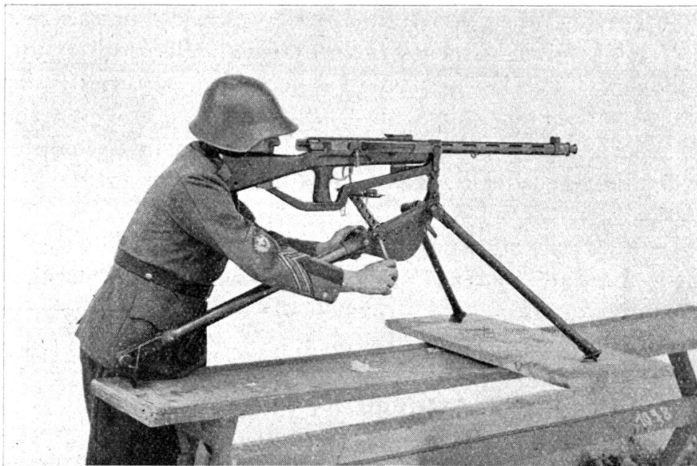
Fig. 1. Le F.M. sur affût léger. Dans la partie postérieure de la bêche, on remarque l'articulation, repliée, pour le tir contre avions.
