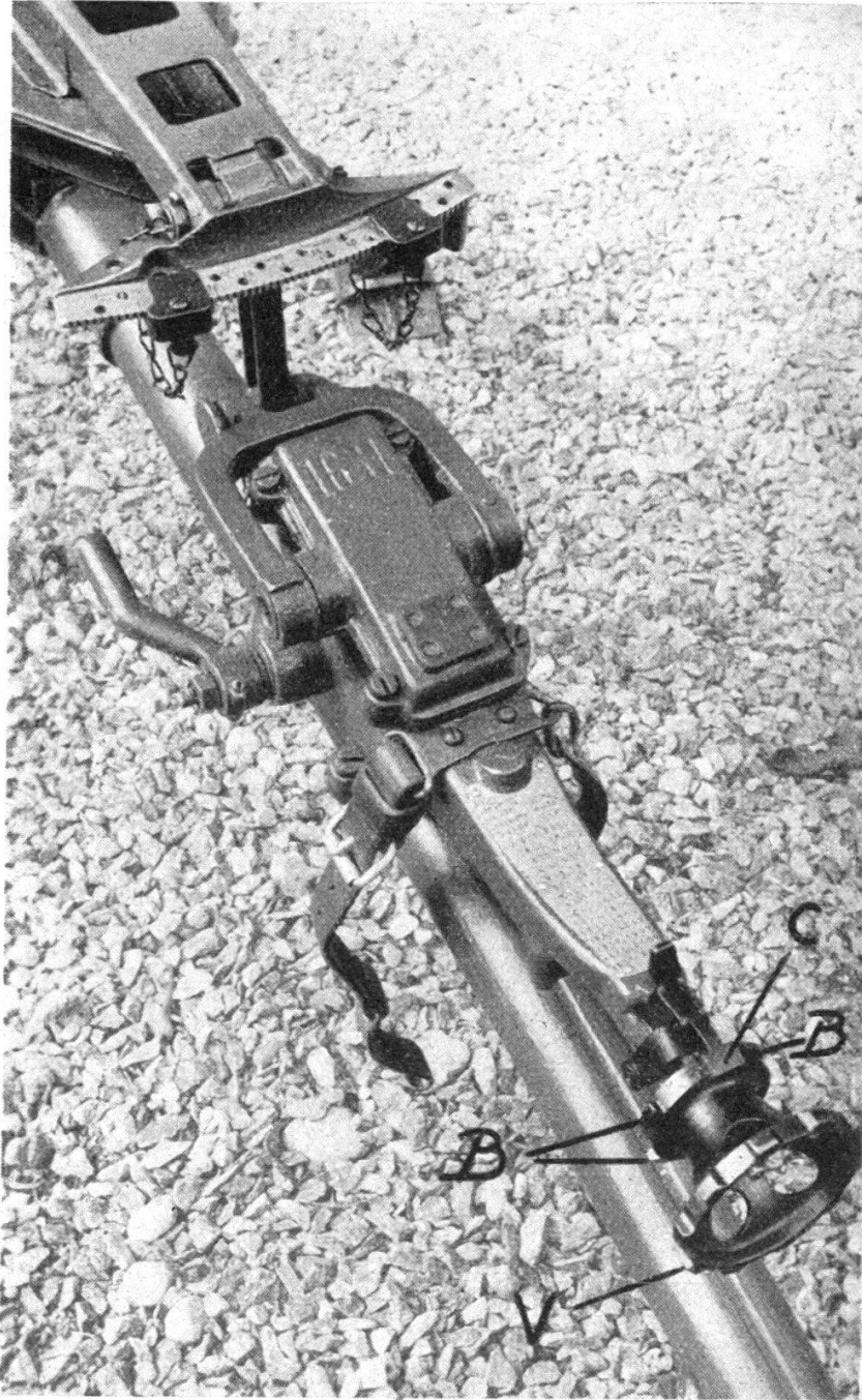
FIG. 4. — Le butoir mobile C a été abaissé. On ne pourra tourner le volant V que dans l'espace libre compris entre les butées B à gauche et à droite.
