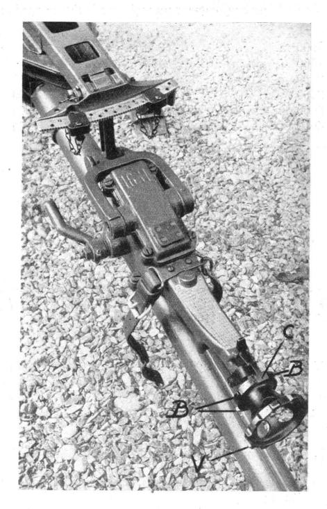
Fig. 4. — Le butoir mobile C a été abaissé. On ne pourra tourner le volant V que dans l'espace libre compris entre les butées B à gauche et à droite.
