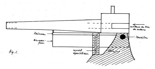
flasques. Cette charnière doit elle-même être largement articulée, puisque l'une des bêches sera fréquemment plus haut, l'autre plus bas que la pièce (position à la pente). Or, une pièce de montagne doit être rustique et facilement démontable, deux conditions que la construction ci-dessus décrite ne permet plus de satisfaire d'une façon encore suffisante.
