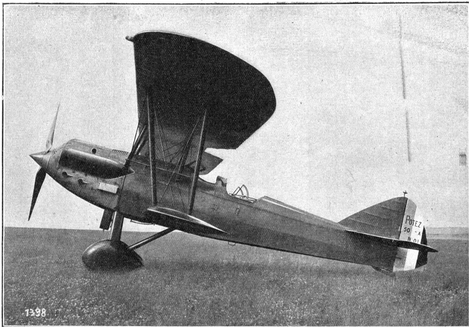
L'avion militaire français Potez 50 A 2 (600 C.V.), appareil d'observation et de reconnaissance.
