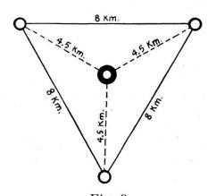
Protection d'un point important à l'arrière du front ou sur tout autre point du territoire national, assurée par trois batteries anti-aériennes puissantes (cal. 100 à 110 mm.), à remorque, auto-traction ou fixes. Installation en défense semi-mobile ou en défense permamente.
