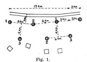
Schéma d'installation des batteries de défense mobile en campagne pour assurer la protection d'un secteur du front de 15 km. de longueur et de 10 km. en profondeur.
