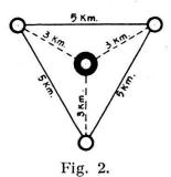
Protection d'un point important à l'arrière du front, assurée par trois batteries anti-aériennes de campagne, adaptées ou spécialisées (cal. 25 à 80 mm.). Installation en défense mobile.
