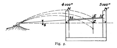
de mire, il suffit d'amener cette barre en regard de l'altitude de la pièce, marquée sur les colonnes d'éclatement, pour obtenir une des positions de batterie B, B' ou B'' (fig. f) puis de faire varier l'inclinaison pour obtenir l'angle de site S (fig. g). Une correction de correcteur agit de même sur l'inclinaison de la barre d'éclatement; mais puisque le correcteur vient d'être relégué au vieux fer par décision du Service de l'artillerie, il est inutile d'insister.
