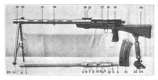
Fig. 1. Fusil Furrer monté sur deux appuis. (Côté gauche sous le fusil, canon de rechange et magasin.)
