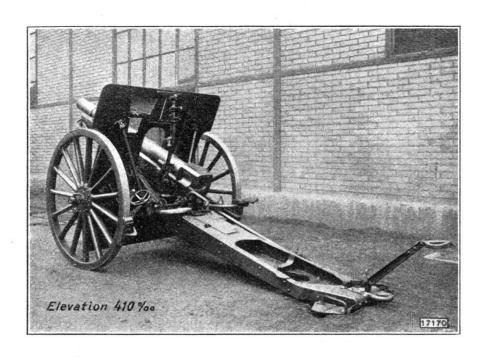
Fig. 1. — Vue latérale de la pièce transformée, sur terrain horizontal, et avec une élévation de 410 % o.
