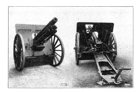
Fig. 2 et 2 a. — Vue de devant et de derrière de la pièce transformée, sur terrain horizontal, et avec une élévation de 410  $^{\rm o}/_{\rm oo}$ .
