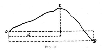
hauteurs sur la feuille d'abaques (trajectoires), à la distance d, mesurée à l'échelle des distances et vérifier si le point obtenu est au-dessous de la trajectoire passant par B.
