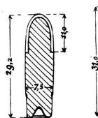
Balle suisse 1899 Schmidt-Rubin cal.7,5 calotte d'aciernickelé. noyau: plomb durci.
