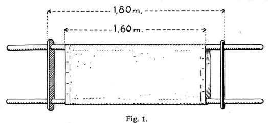
Les traverses les plus pratiques sont des petites planchettes de 8 à 10 cm. de large et 80 cm. de long, à l'extrémité desquelles sont percés deux trous pour laisser passer les montants. (Fig. 1
