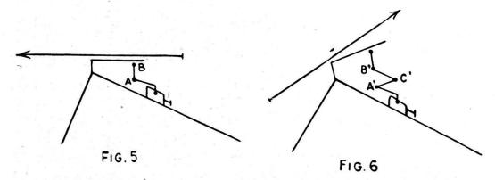
Dans le tir ordinaire, les points A' et C' se confondraient en A où une goupille à ressort maintiendrait l'articulation rigide.
