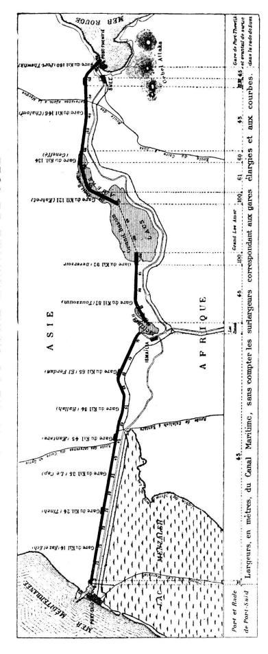
La profondeur minimum du canal maritime est de 10 mètres. — Les largeurs du canal maritime sont comptées à la profondeur de 10 mètres.
