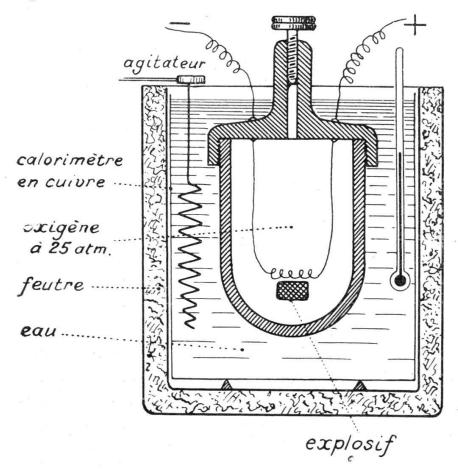
Fig. 1. — Bombe calorimétrique de Berthelot.
