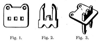
Dans la plaque, côté inférieur, sont percés trois trous carrés, dont les deux extérieurs reçoivent les griffes. Celui du milieu sert à river le crampon. Deux autres trous percés du côté opposé de la plaque sont destinés à fixer le clou au moyen de pointes (fig. 3). La semelle, entièrement cloutée, présente l'aspect reproduit par la fig. 4.
