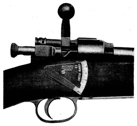
Le contrôleur Ely. — Sprinfield à magasin équipé avec le contrôleur modèle A. L'indicateur est au point « ouvert » (Off.)
