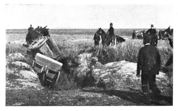
Fig. 2. — Canon de campagne Krupp, à recul sur l'affût, au passage d'un fossé profond pendant des essais de roulage en Italie.
