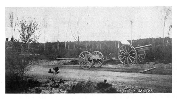
Fig. 10. — Canon de campagne de 7.5 cm. L/50, à recul sur l'affùt, franchissant une poutre fixée en travers de la piste de roulage de Tangerhütte.
