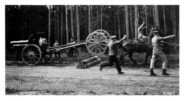
Fig. 5. — Canon de siège à recul sur l'affût traîné par des chevaux et franchissant un obstacle de bois au polygone de Tangerhütte. Passage de l'avant-train.
