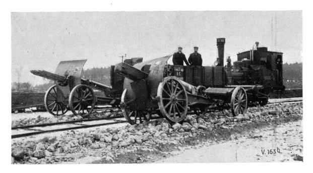
Fig. 41. — Chariot porte-corps et affût, avec avant-train d'un canon de siège, roulant sur de grosses pierres sur la piste de roulage de Meppen.
