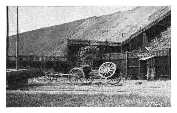
Fig. 15. — Caisson à munitions franchissant des tremplins de bois disposés alternativement sur la piste de roulage d'Essen.
