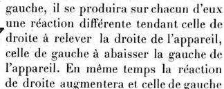
diminuera car l'aileron de droite attaque l'air sous un angle plus grand que précédemment et celui de gauche sous un angle moindre. On peut donc par la manœuvre des ailerons ramener la surface sustentatrice de l'appareil dans le plan horizontal et, par conséquent, contrarier les oscillations de roulis.
