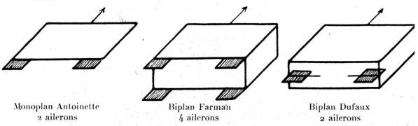
Pour bien saisir le fonctionnement des ailerons, prenons le cas d'un monoplan avec ses deux ailerons, mobiles dans les deux sens autour de charnières fixées sur l'arête opposée à l'attaque.
