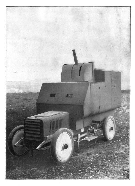
Automobile blindée de la Rheinische Metallwaaren und Maschinenfabrik pour la poursuite des ballons dans la guerre de siège.
