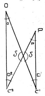
$P = \text{angle sous lequel l'intervalle } C_1 \ C_2 \text{ est}$  vu du point de pointage.
