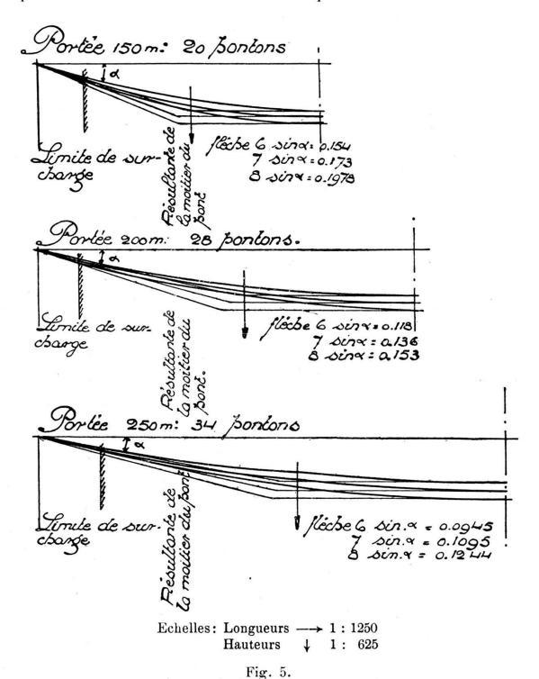
Schéma des chaînettes soit paraboles analysées.
