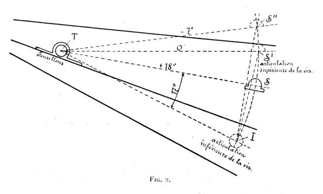
T'étant le centre de tourillons du porte-berceau (Fig. 2), I le centre de l'articulation inférieure de la vis de pointage et S celui de l'articulation supérieure de cette vis lorsque le canon est au pointage maximum positif (+ 18 degrés), l'angle STJ est égal à 17°.
