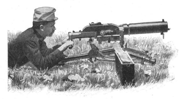
Fig. 2. — Mitrailleuse Schwarzlose au tir, dans sa position la plus basse.
