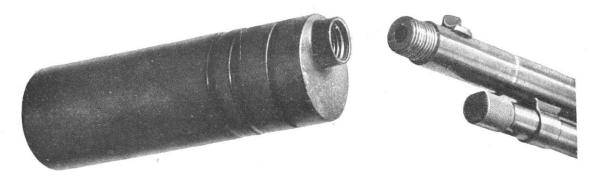
Photographie montrant la méthode d'attachement du "Silencer" au fusil.
