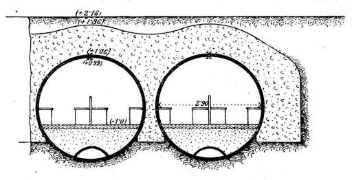
Fig. 6. — Abri en tuyaux de béton armé à l'épreuve des éclats d'obus.
