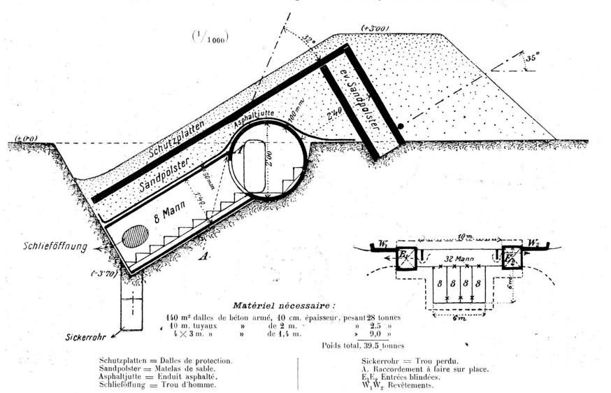
ètre question de l'emploi du béton ordinaire dans la fortification de campagne proprement dite, attendu que le béton demande au moins deux à trois semaines pour sécher, sans parler du temps nécessaire pour réunir les matériaux et faire le béton. Le grand avantage du béton armé, indépendamment de la plus grande résistance, réside dans le fait qu'on peut préparer d'avance et
