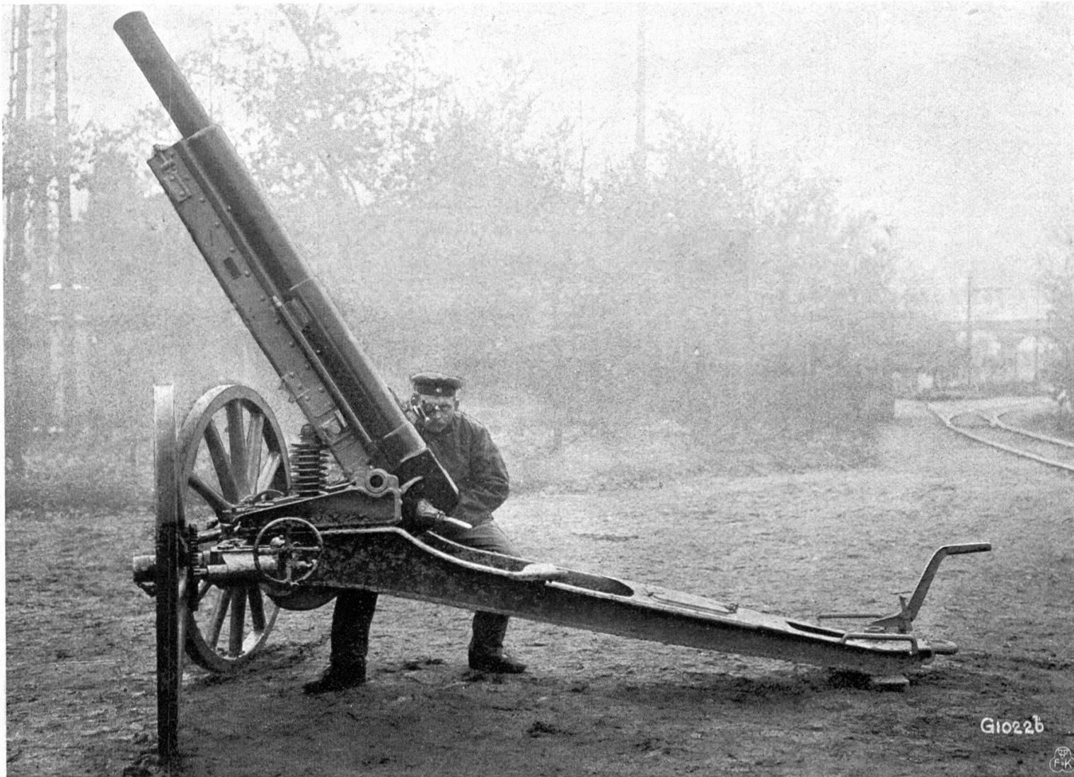
Canon de 6,5 cm. L/35 système Krupp, pour le tir contre les ballons, sur affût de campagne.
