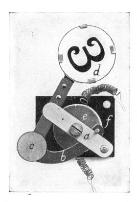
Fig. 3. Index de l'indicateur électrique.
