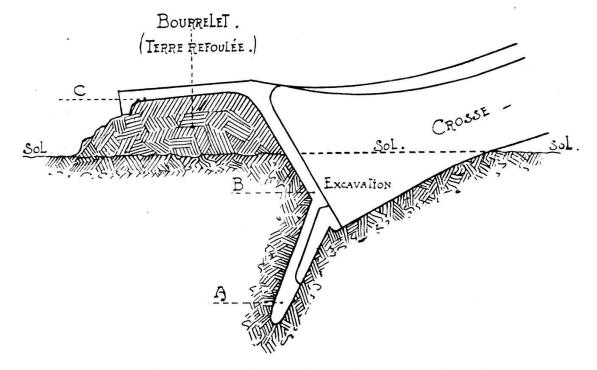
mique déterminant le «cabré» de la pièce et la démolition progressive du bloc prismatique de terre servant d'appui à la bêche. C'est l'inconvénient qu'on avait observé dans les précédents essais.
