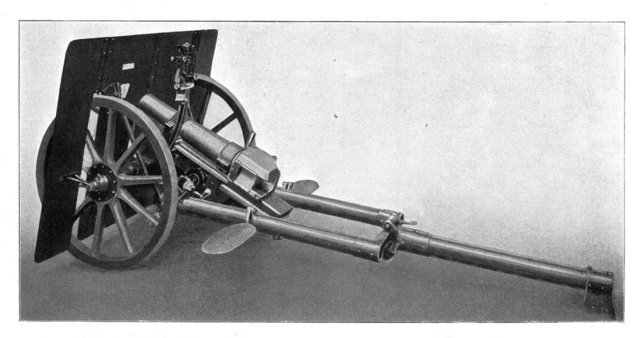
Canon de montagne à tir rapide de 7,5 cm à recul sur l'affût automatiquement variable, Système Ehrhardt, Mod. 1905 N° 2. Pièce à l'élevation maxima.
