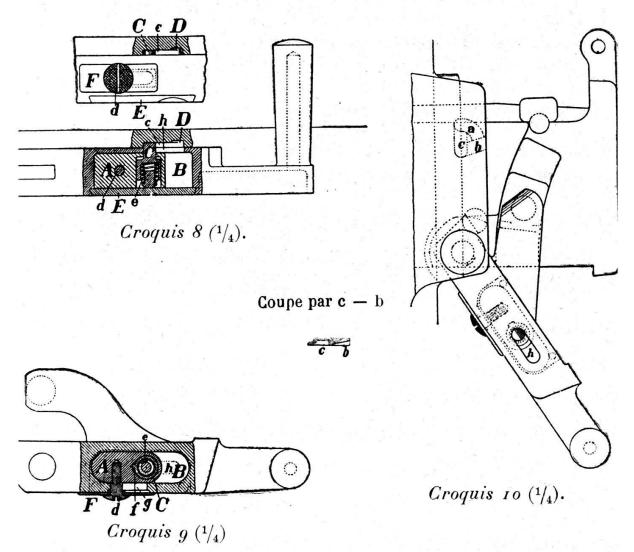
la nervure f empêchent la goupille d'arrêt C, entaillée d'un côté, de tourner dans le glissoir A.
