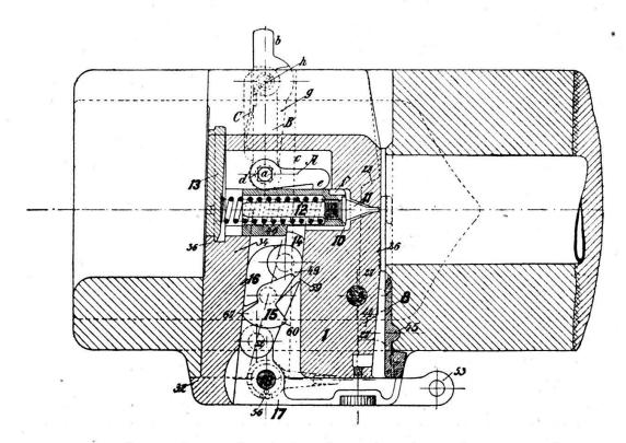
Croquis 2. Coupe horizontale, mécanisme de percussion au repos (1/4).
