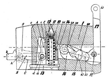
Croquis 5. Mécanisme de percussion au repos.
