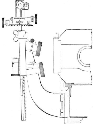
dérive normale. Fig. 16. — Hausse à lunette système Krupp. Assemblage Il pointe ensuite sur le berceau d'une pièce à recul sur l'affût.
