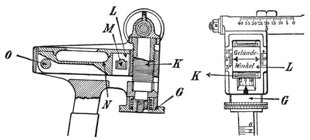
Fig. 4. — Hausse-niveau, coupe longitudinale sur le niveau.
