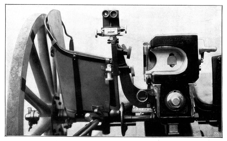
Fig. 19. Hausse Krupp à lunette pour canon à recul sur l'affût. Vue de derrière.
