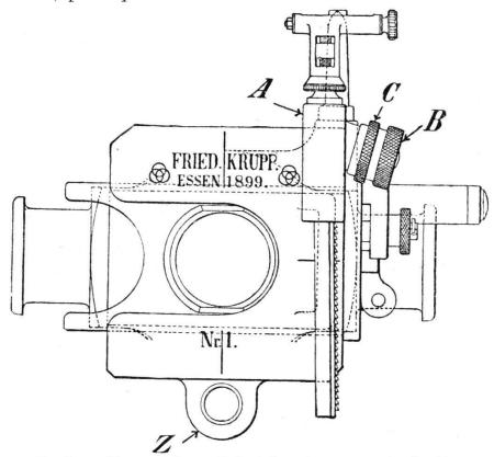
Fig 1. — Hausse-niveau fixée à la culasse, vue de derrière.
