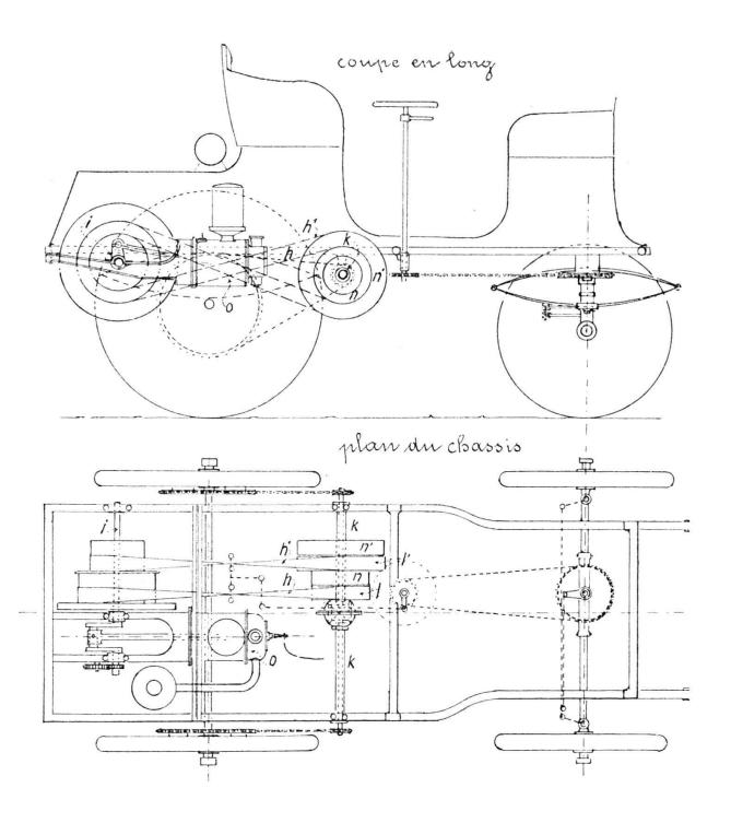
Fig. 3 et 4. Schéma d'un automobile type Benz 1895.
