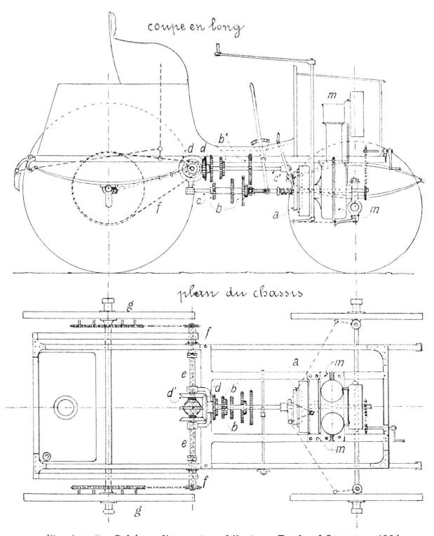
Fig. 1 et 2. Schéma d'un automobile type Panhard-Levassor 1894.
