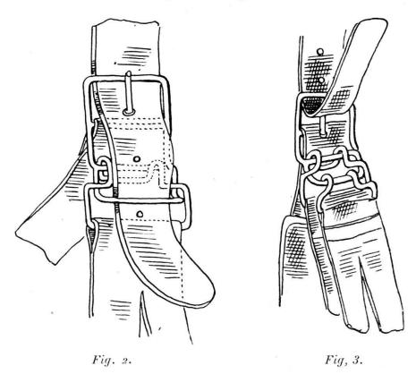
Si l'on veut fourrager, un seul petit mouvement suffit donc pour enlever le mors, qui peut être remis en place avec la même facilité et rapidité. On se sert pour cela des montants fixés aux canons du mors, de sorte que l'on n'a pas besoin d'introduire celui-ci avec la main dans la bouche du cheval.
