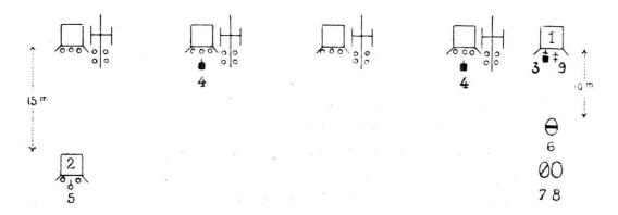
Un arrière-train de caisson (1), placé sur la ligne des pièces à l'aile de la batterie où commande le capitaine (3), fournit à celui-ci un abri ou un observatoire. A côté du capitaine, la lunette de batterie (9).
