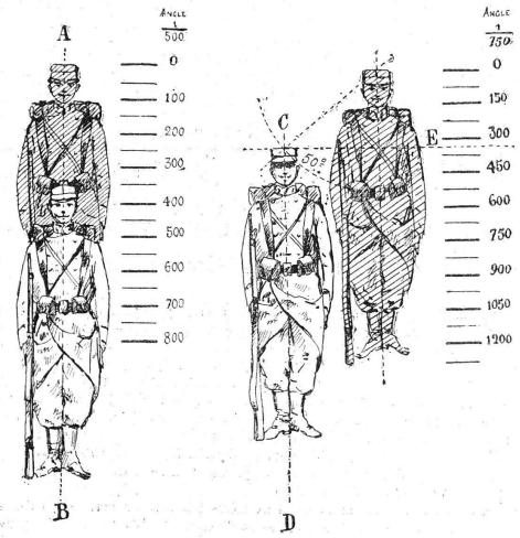
Aspect que présente un fantassin vu à l'aide du prisme au 1/500 (stadimètre) suivant que la médaille est tenue l'anneau à 450 (figure de gauche) ou verticalement (figure de droite). On lit la distance dans le stanhope ci-contre dans la colonne 1/500 (cas de la figure de gauche) ou dans la colonne 1/750 (cas de la figure de droite).
